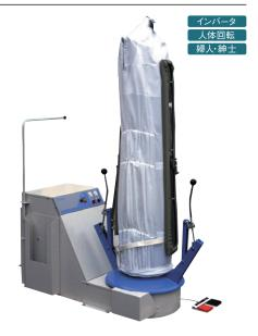
GF-250/350GFの長所を受け継ぎ、当社比5倍の蒸気ヒーターを搭載することで、素材を選ばず美しい仕上げを実現します。ストレート型、T型、袖差しなど各種オプションを豊富に用意。
