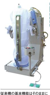
新たに大容量蒸気ヒーターを搭載
