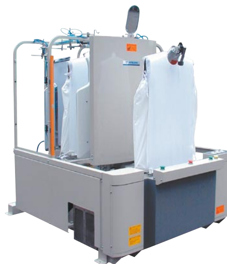
DB-500 ダブルボディープレス (1380×1886×1715mm)
